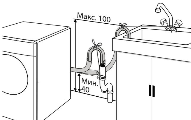
– Чтобы не допустить попадания грязной воды обратно в стиральную машину, конец шланга должен входить в сливное отверстие на глубину **не более 15 см**. Если он слишком длинный, укоротите его.
