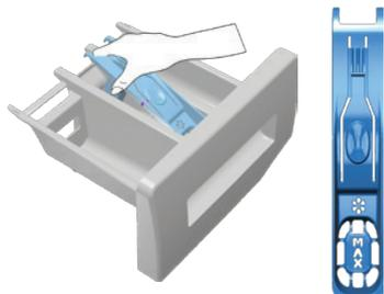
Поднимите заднюю часть сифона, чтобы снять его, как показано на рисунке. После чистки установите сифон на место и надавите на его переднюю часть вниз, чтобы убедиться, что фиксирующий язычок защелкнулся.
