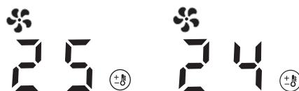
Если установленная температура **на 1–2 °С выше** температуры окружающей среды, прибор будет работать в режиме низкого нагрева.
